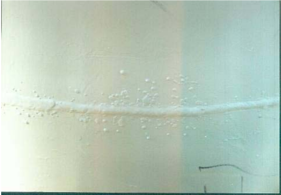
عکس شماره ۱۲: اکتفا به انجام عملیات بلاستینگ و عدم توجه به رفع سایر موانع از قبیل جوش های نامناسب، لبه های تیز، طراحی نامناسب و ..
